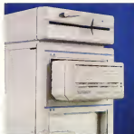
L'inserimento del Data Pac avviene in modo automatico mediante un apposito motore interno. A macchina spenta conviene estrarre il disco dal suo alloggiamento.
